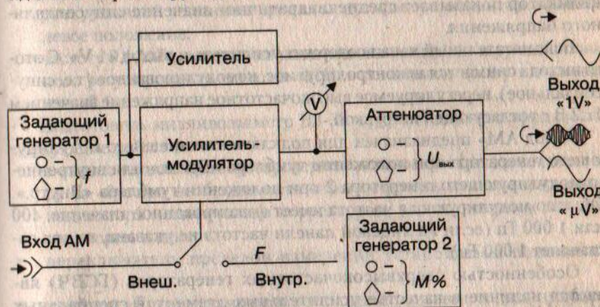
Рис. 2.15. Структурная схема ГВЧ
