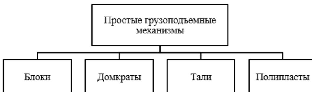
Рисунок 1 «Классификация простых грузоподъемных механизмов»
