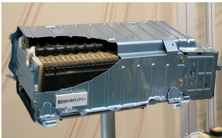
Рисунок 2 - «Toyota NHW20 Prius. Аккумуляторная батарея»
