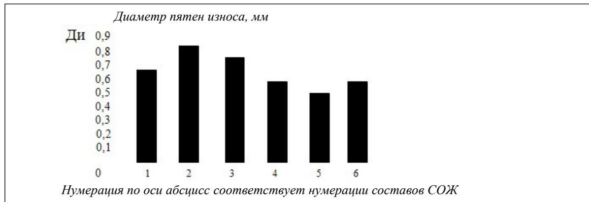
Рис. 2. Противозносные свойства олигомерсодержащих смазок (составы №1-4) при концентрации ПАВ: 1-0%; 2-2%; 3-4%; 4-0,3%, полимерсодержащей смазки (состав №5) и ТС «Castrol Iloform PN 350»
