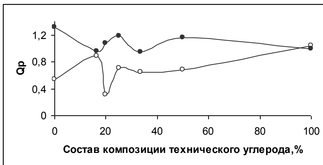
Рисунок 4 - Зависимость коэффициента набухания Q_p резиновой смеси на основе натурального каучука (○) и бутадиен-стирольного каучуков (●) от содержания наполнителя (добавка + основа) П 267Э + П 161
