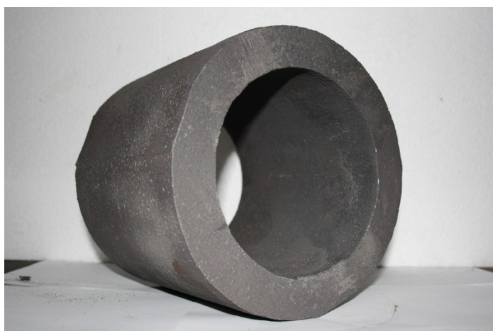
Рисунок 2 - Прессованная втулка из высокомедистого чугуна (9,2 % \text{Cu} ). Степень деформации 51 %.
