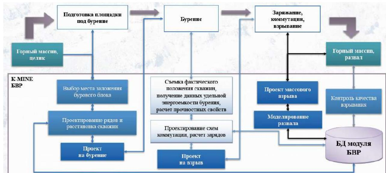
Рисунок 2 – Полный цикл проектирования и управления буровзрывными работами в карьере
