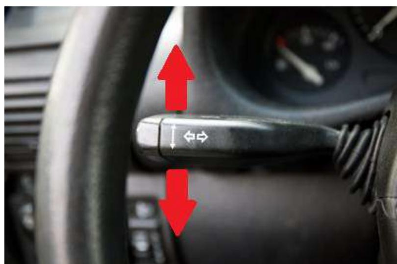
Рисунок 4 – Подрулевой переключатель указателя поворотов
